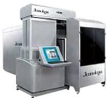
傳統方式透過手工刷洗布料表面，使丹寧布料內層的白色紗線外漏。透過雷射設備取代傳統砂紙，客人可指定設計局部刷白區塊與製作特殊的丹寧布料，然而此工法需使用化學添加劑以突顯刷白表面的效果。透過新引進的雷射設備，如興不僅不需使用有害化學物質，更大幅降低人工勞動成本，我們於 2018 年全面停止使用有害化學物質（噴射 PP 高錳酸鉀）。
